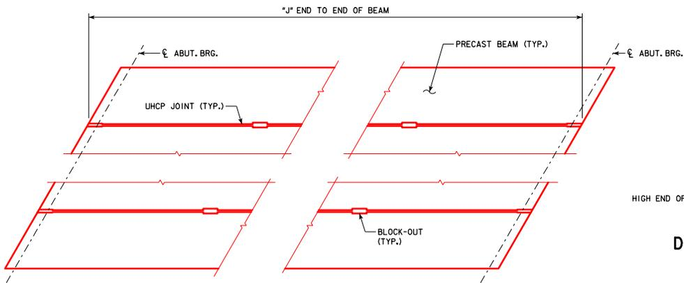
**PART PLAN SHOWING LONGITUDINAL UHPC JOINTS BETWEEN BEAMS**
