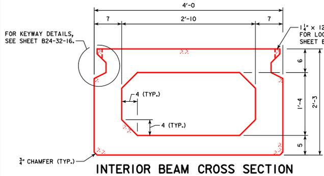
**INTERIOR BEAM CROSS SECTION**
