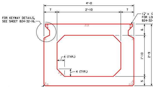
**INTERIOR BEAM CROSS SECTION**
