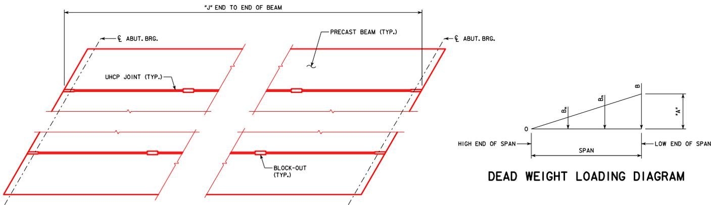
**PART PLAN SHOWING LONGITUDINAL UHPC JOINTS BETWEEN BEAMS**
