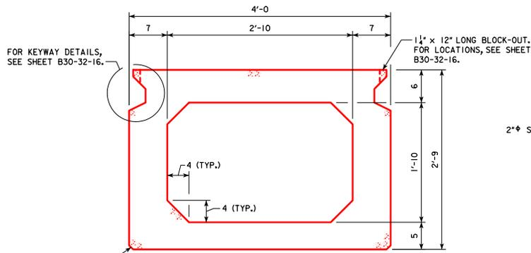
**INTERIOR BEAM CROSS SECTION**
