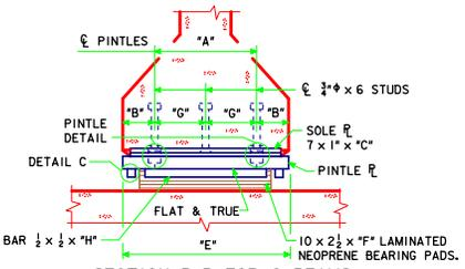
**SECTION B-B FOR C BEAMS**
