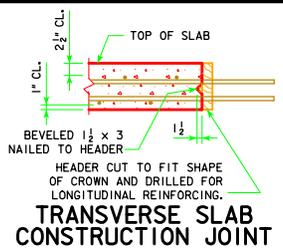
**TRANSVERSE SLAB CONSTRUCTION JOINT**
