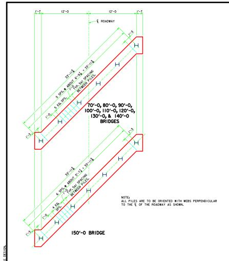
PILE PLAN - 45° SKEW STEEL PILING
