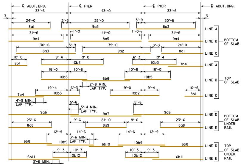
**PLACEMENT FOR LONGITUDINAL REINFORCEMENT**
