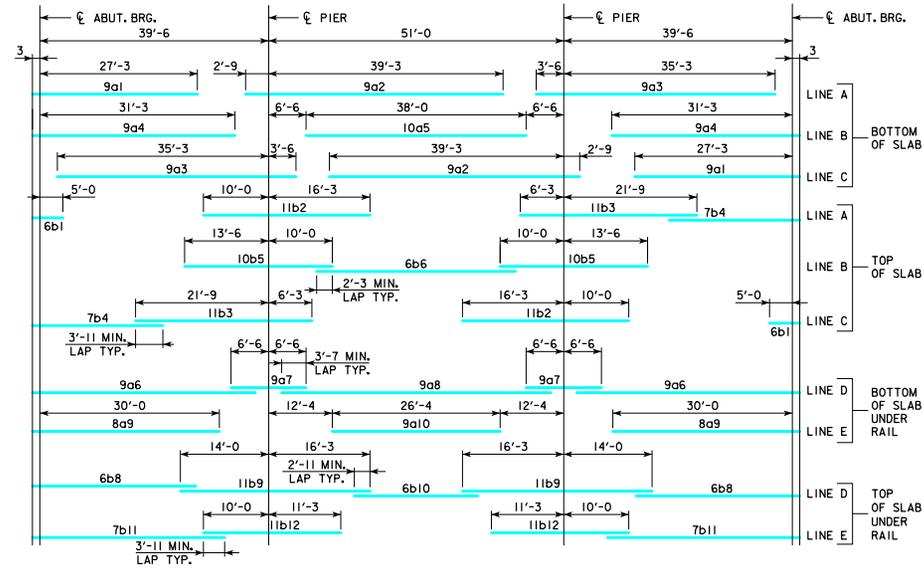
**PLACEMENT FOR LONGITUDINAL REINFORCEMENT**
