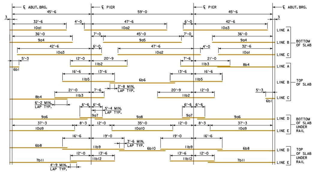
**PLACEMENT FOR LONGITUDINAL REINFORCEMENT**
