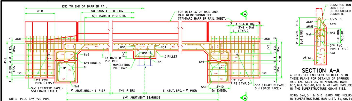
**PART LONGITUDINAL SECTION NEAR GUTTER LINE**
