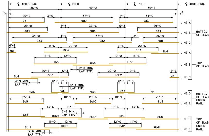
**PLACEMENT FOR LONGITUDINAL REINFORCEMENT**
