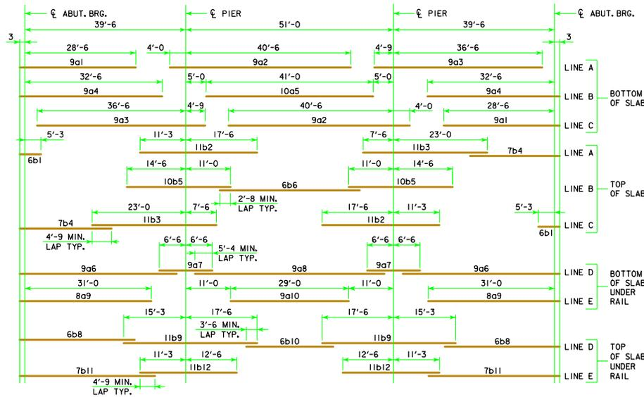
**PLACEMENT FOR LONGITUDINAL REINFORCEMENT**
