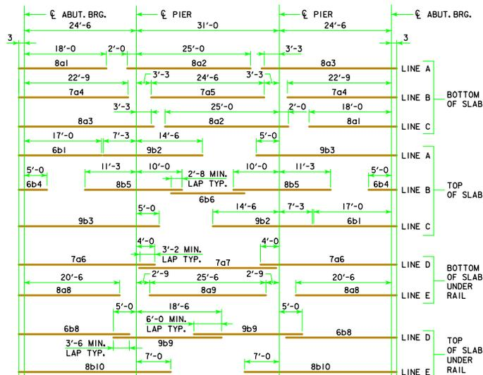
**PLACEMENT FOR LONGITUDINAL REINFORCEMENT**
