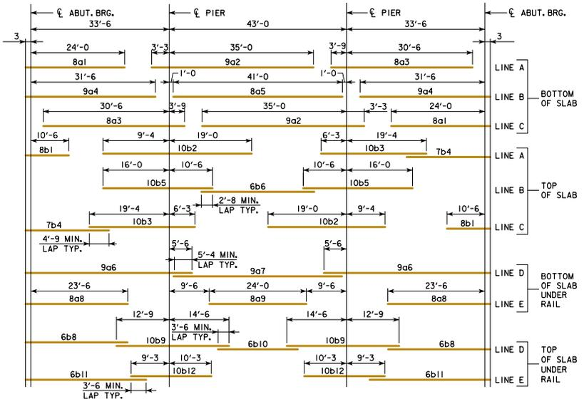
**PLACEMENT FOR LONGITUDINAL REINFORCEMENT**
